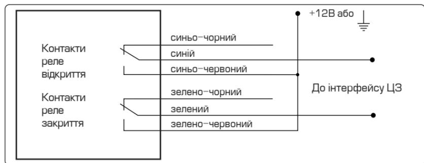
*Схема підключення зі змінною полярністю для управління ЦЗ*
