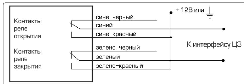
*Схема подключения с меняющейся полярностью для управления ЦЗ*
